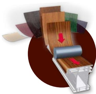
Schneller Wechsel von Dekorfolie und Profilgeometrie in der Produktion. Eine fast unbegrenzte Anzahl von Kombinationsmöglichkeiten eröffnet sich.
